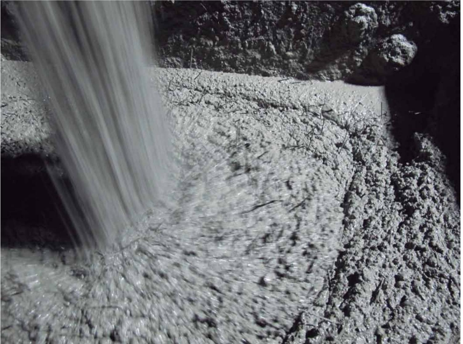
Este aditivo sin cloruros tiene un peso específico de 1.45 kg/L, sin duda un líquido denso que guarda en su interior una tecnología de aceleramiento que apela a principios químicos innovadores en la construcción. Este líquido contiene una dispersión especial de sólidos en suspensión que ofrece nuevas superficies de precipitación y cristalización a los compuestos del cemento durante su reacción.
