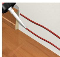
7. Sostener el objeto por algunos instantes hasta que la pieza se mantenga en la ubicación deseada. Es posible reubicar el elemento a pegar durante los primeros minutos, después de la aplicación. De ser necesario coloque elementos de sujeción temporal (cintas adhesivas, cuñas, etc.), para mantener las partes unidas y en posición, durante el tiempo de curado inicial necesario.
