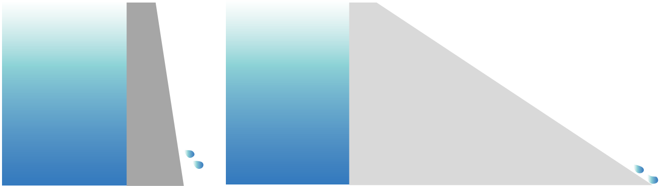
Figura 8. Igual caudal de infiltración para hormigones de diferentes calidades y geometrías.
