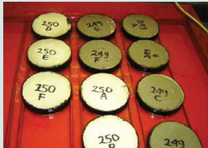
Figura 13. Especímenes de mortero semisumergido con y sin Sika 1 al cabo de 4 horas de absorción capilar.
