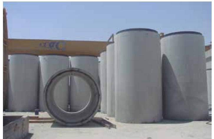
Conducción de agua - Tubería en Hormigón
