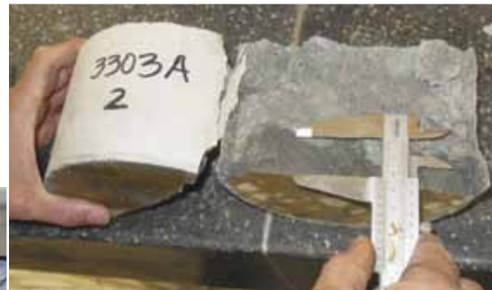
Determinación de la profundidad de penetración de agua.
