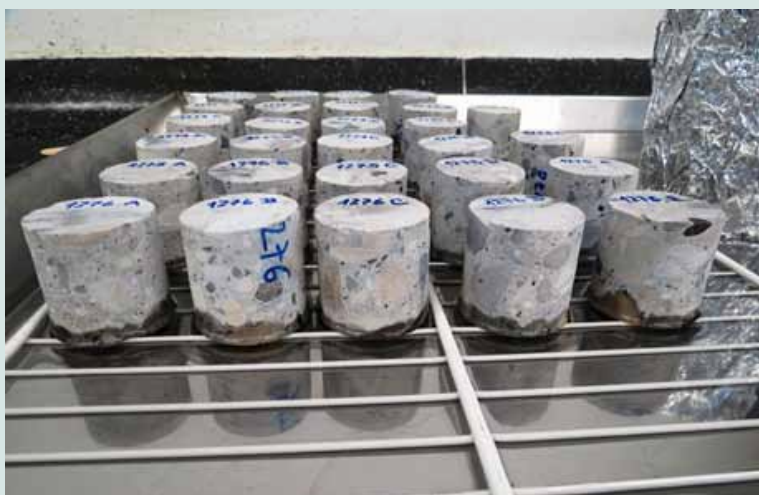
Figura 19. Ensayo de absorción capilar de hormigón de acuerdo con la norma SIA 262-Anexo A.
