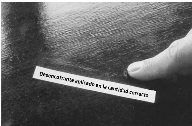
Sobre un encofrado liso se puede probar la cantidad correcta y la uniformidad con la “prueba del dedo”. Al pasar el dedo no deben quedar marcas visibles ni formarse acumulación del producto. El exceso debe retirarse de una superficie horizontal usando una esponja de goma o de espuma. Si se ha aplicado el producto en exceso sobre una superficie vertical o inclinada, se verán rayas en la superficie o acumulación en la base. El exceso debe retirarse con un trapo o esponja.
