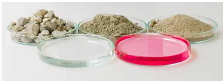
Fig. 6-1: Componentes del diseño de la mezcla del hormigón proyectado: gravilla, agua, cemento, superplastificante, arena (de izquierda a derecha)
