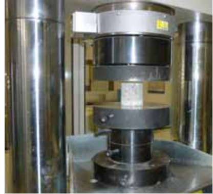
Fig. 8-15 / 16: Perforación de núcleo de una muestra de hormigón proyectado (izq) y medición de la resistencia a la compresión de un núcleo (der).
