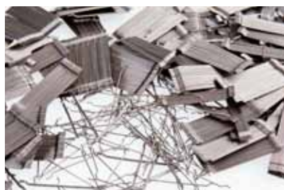
Fig. 5-3: Fibras de acero para mejorar la absorción de energía del hormigón
