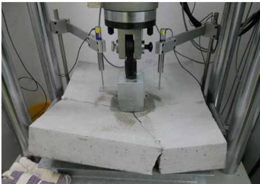
Fig. 5-5: Prueba de absorción de energía de hormigón proyectado reforzado con fibra según EN 14488-5
