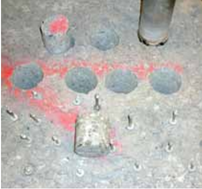
Fig. 8-15 / 16: Perforación de núcleo de una muestra de hormigón proyectado (izq) y medición de la resistencia a la compresión de un núcleo (der).
