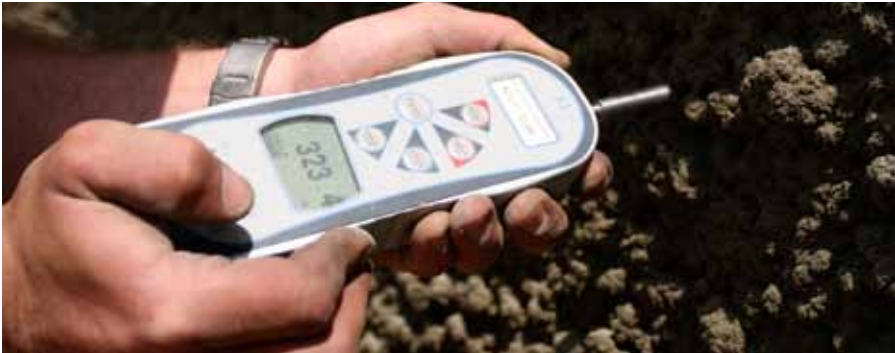
Fig. 8-12: Penetración del hormigón proyectado fresco con un penetrómetro digital (Mecmesin AFG 1000)
