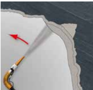
Fig. 8-5: 2a capa hormigón proyectado - estabilización de excavación, generalmente con refuerzo de acero
