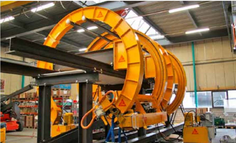
Fig. 10-7: Equipo robótico Aliva* de proyectado de hormigón para máquina TBM
