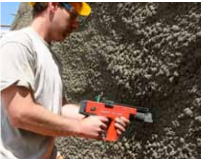
Fig. 8-13 / 14: Penetración de hormigón proyectado joven con pernos empleando un Hilti DX 450-SCT (izq) y medición de parte que sobresale del perno para determinar la penetración
