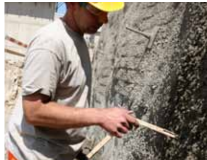
Fig. 8-13 / 14: Penetración de hormigón proyectado joven con pernos empleando un Hilti DX 450-SCT (izq) y medición de parte que sobresale del perno para determinar la penetración
