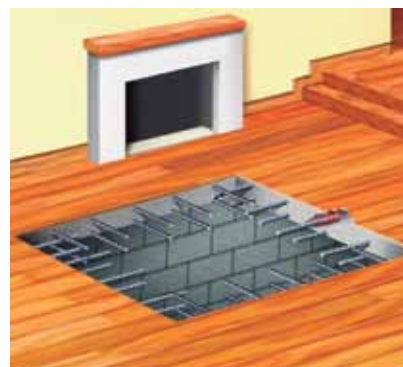
Recrecimiento de losas, conexiones de muros con losas.
