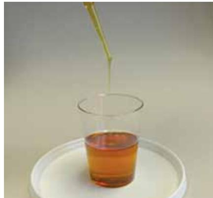
Dada la baja viscosidad de Sika Injection-201, puede penetrar en fisuras mayores de 0,2mm de ancho.
