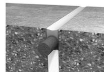
5. Insertar el Sika®Rod a la profundidad requerida de la junta y si es necesario, aplicar una imprimación. Aplicar Sikaflex®-103 Pisos en la junta asegurando que el mismo quede en pleno contacto con los lados de la junta y evitando que quede aire atrapado.
