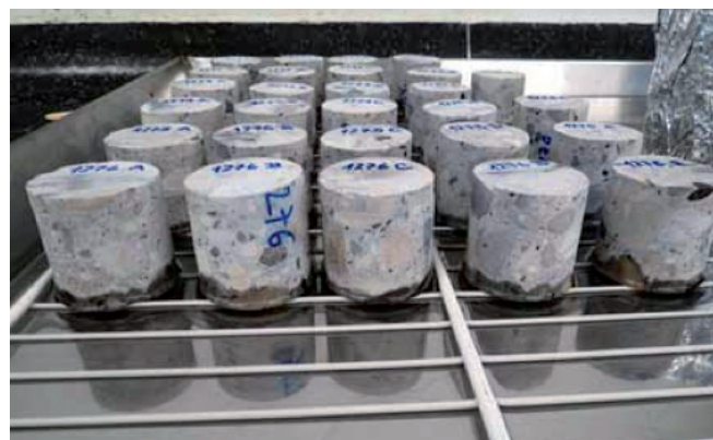
Figura 03. Ensayo de absorción capilar de concreto de acuerdo con la norma SIA 262-Anexo A.
