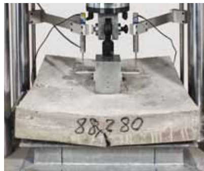
Ensayo de panel cuadrado: EN 14488-5
