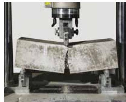
Ensayo de viga: EN 14651
