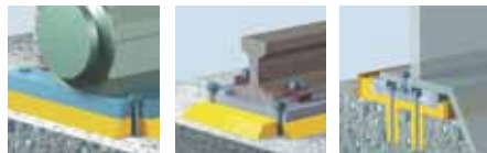
Bases de equipos y maquinaria pesada. Apoyo y fijación de rieles. Grouting y anclaje de pernos.
